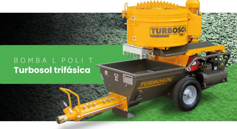
Poli T es una bomba modular de tornillo sinfín ideal para ser equipada con distintos componentes según la aplicación que se tiene que realizar. Si está acompañada por la mezcladora planetaria, Poli T se convierte en un verdadero centro autónomo de mezcla y bombeo.
