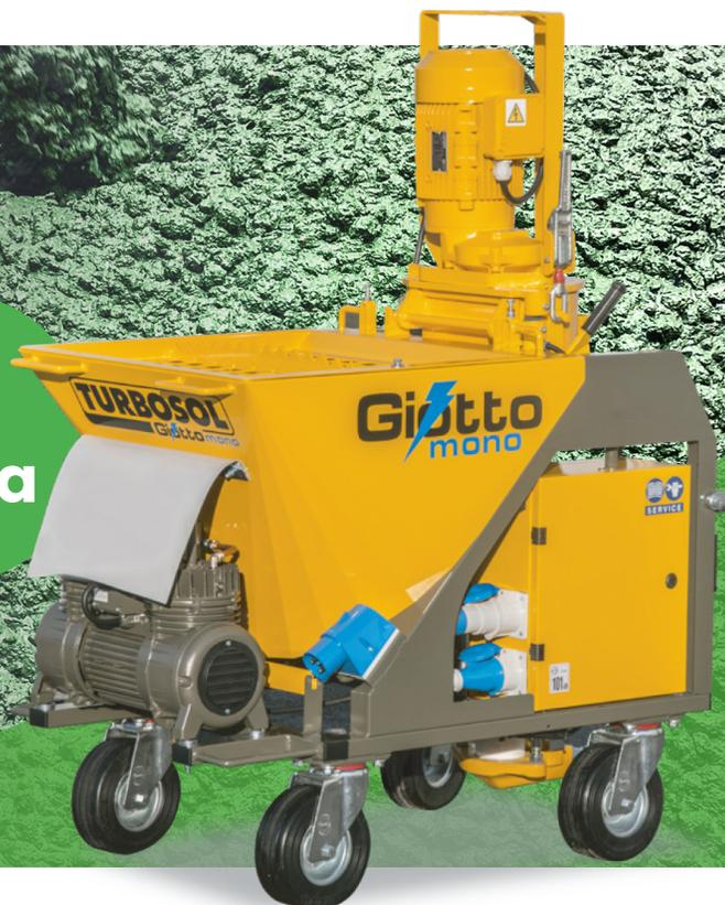
GIOTTO MONO es una revocadora monofásica proyectada para dosificar, mezclar, bombear y proyectar materiales premezclados secos en sacos o de silo. Está construida con un bastidor portante modular en acero plegado que asegura alta resistencia a todo tipo de esfuerzo. Está equipada con un motorreductor y un variador de 3 velocidades que garantizan máxima eficiencia. Las piezas de desgaste que la componen son intercambiables y universales.
