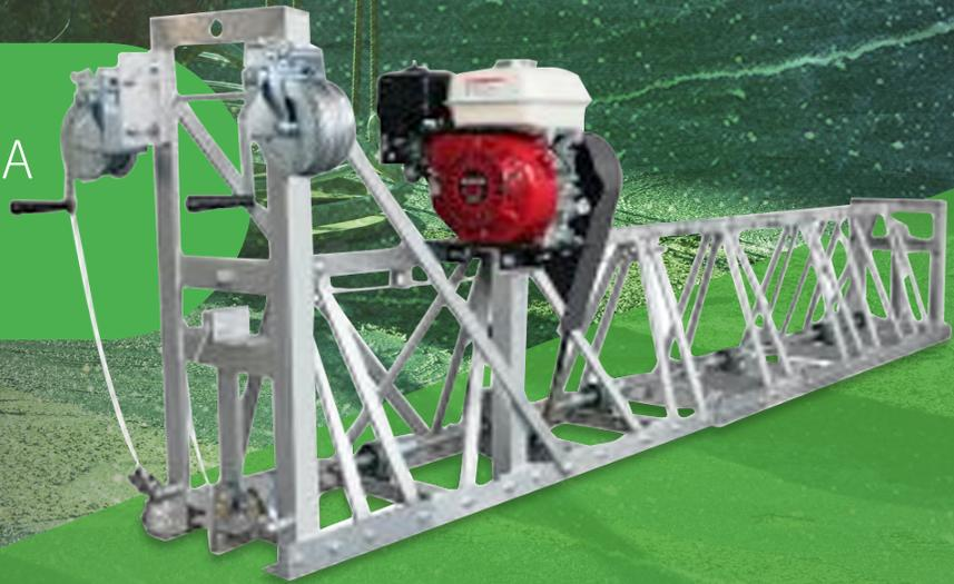
La Cercha Vibradora Reticulada de 6 metros, impulsada por motor bencinero, redefine la eficiencia y la potencia en la compactación de concreto. Diseñada para abordar proyectos de gran envergadura, esta cercha vibradora ofrece un rendimiento excepcional, garantizando un acabado profesional en superficies de concreto de cualquier tamaño.
