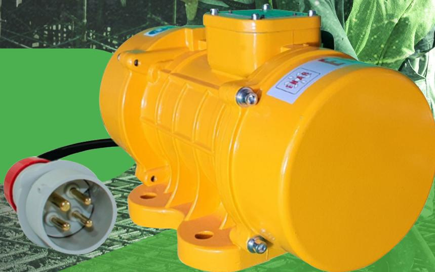
Vibradores externos MARCA ENAR Monofásicos y Trifásicos. Excéntricas ajustables para seleccionar la fuerza requerida hasta 600 kgf. Carcasa de aluminio de alta resistencia.
