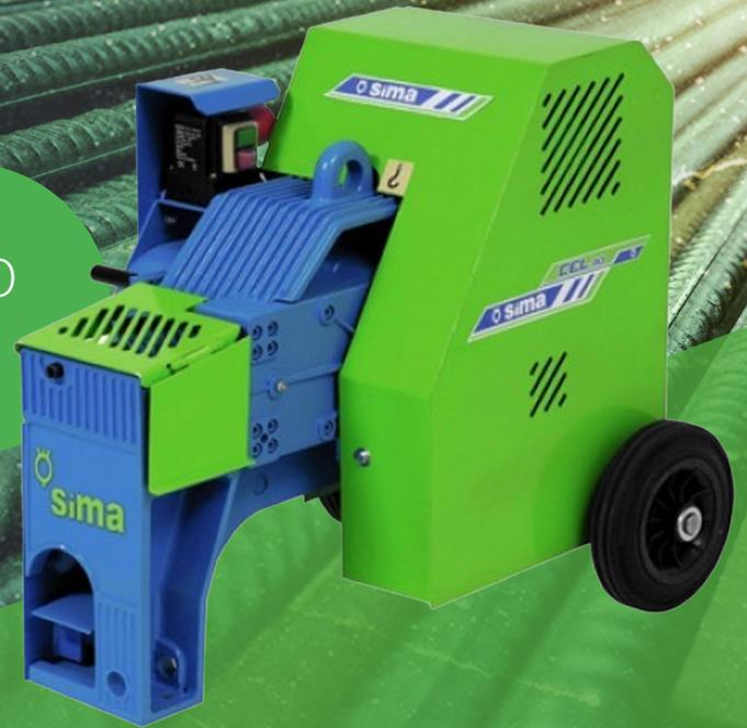
La Cortadora SIMA CEL-36, con una potencia de 1.5 kW y opciones de voltaje de 230V y 400V, es la solución perfecta para el corte preciso de barras de acero. Con un elevado estándar de protección al usuario, alta productividad y baja mantención, esta cortadora de la marca SIMA (España) ofrece eficacia comprobada, consolidándose como sinónimo de calidad e innovación permanente.
